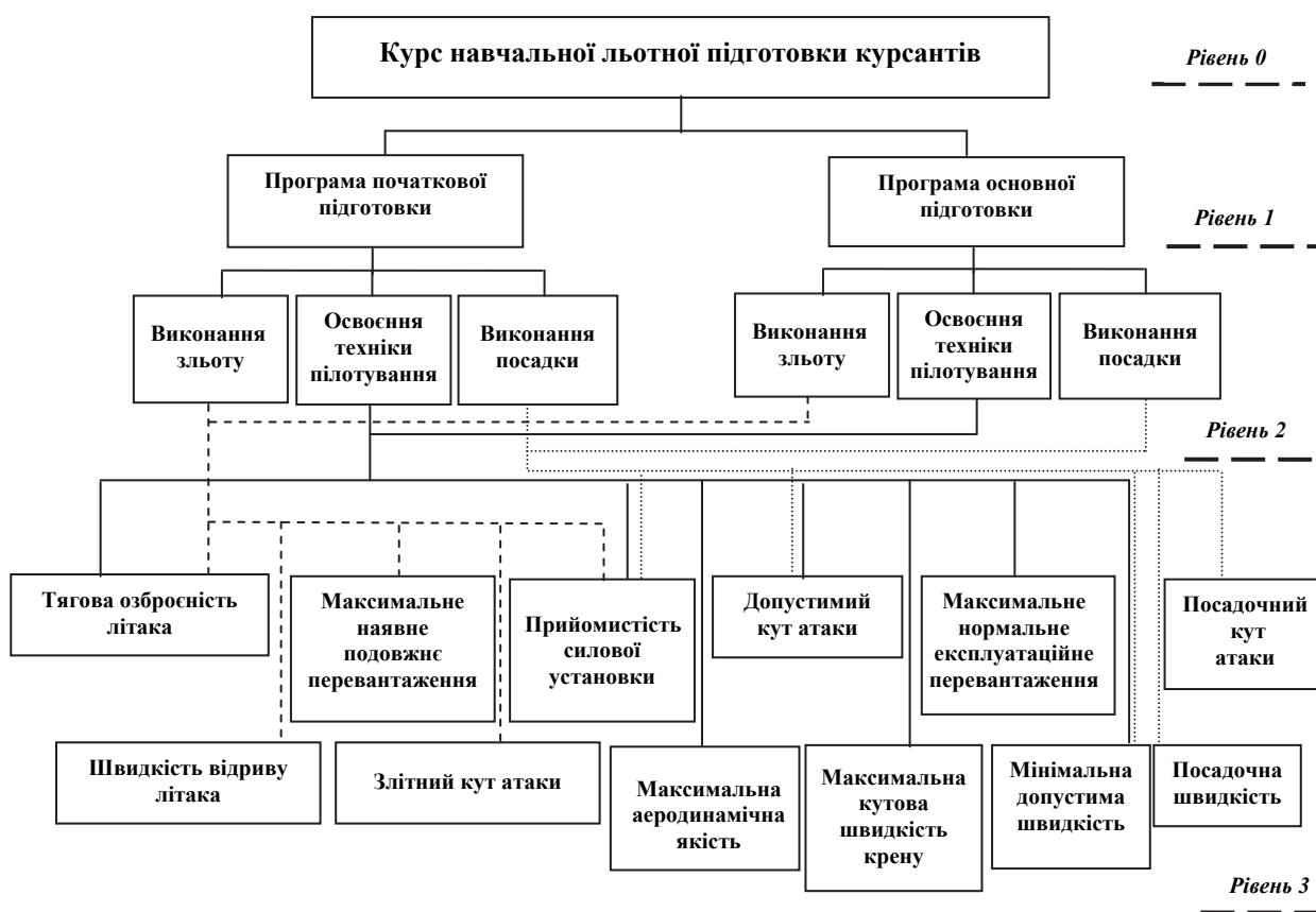
Рис. 1. Ієрархічна структура факторів, що обумовлюють ступінь пристосованості НБЛ до забезпечення вирішення задач базової навчальної льотної підготовки курсантів
