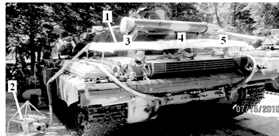
Рис. 6. Розміщення проточного теплового екрану над танком:
