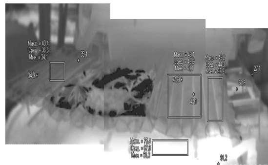
Рис. 9. Оптичне та термографічне зображення кормової частини танка, що вкрита проточним тепловим екраном
