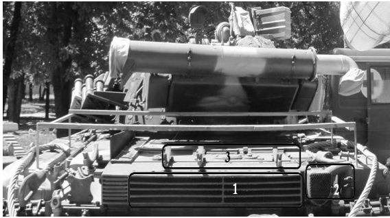
Рис. 8. Розподіл підвищеної температури елементів танка за ділянками під час дослідження: 1 – 90 \pm 5^\circ\text{C} , 2 – 120 \pm 10^\circ\text{C} , 3 – 60 \pm 5^\circ\text{C}
