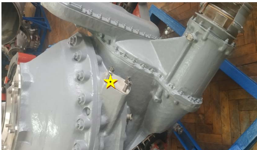
Рис. 6. Точка виміру вібрації на головному редукторі ВР-8А
