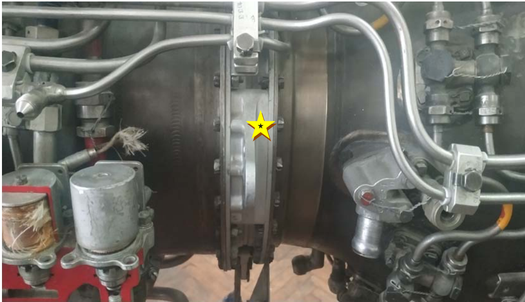
Рис. 4. Точка виміру вібрації на коробці перепуску повітря ГТД ТВ2-117 вертольота Мі-8
