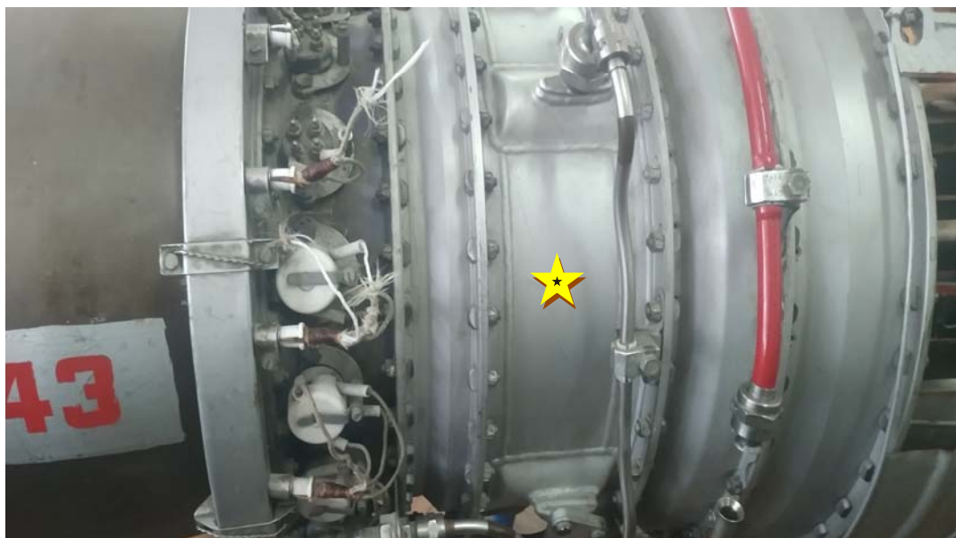
Рис. 5. Точка виміру вібрації на корпусі третьої опори ГТД ТВ2-117 вертольота Мі-8
