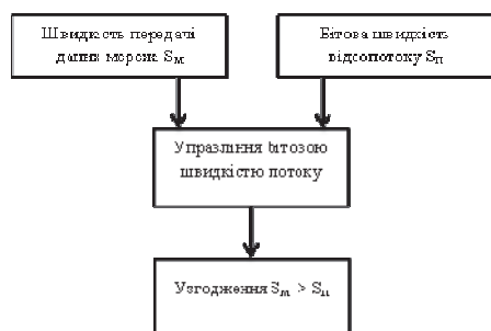
Рис. 1. Схема узгодження бітової швидкості відеопотоку і швидкості передачі даних в мережі
