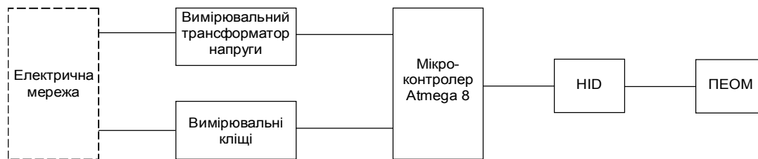
Рис. 3. Структурна схема пристрою для вимірювання показників якості електричної енергії
