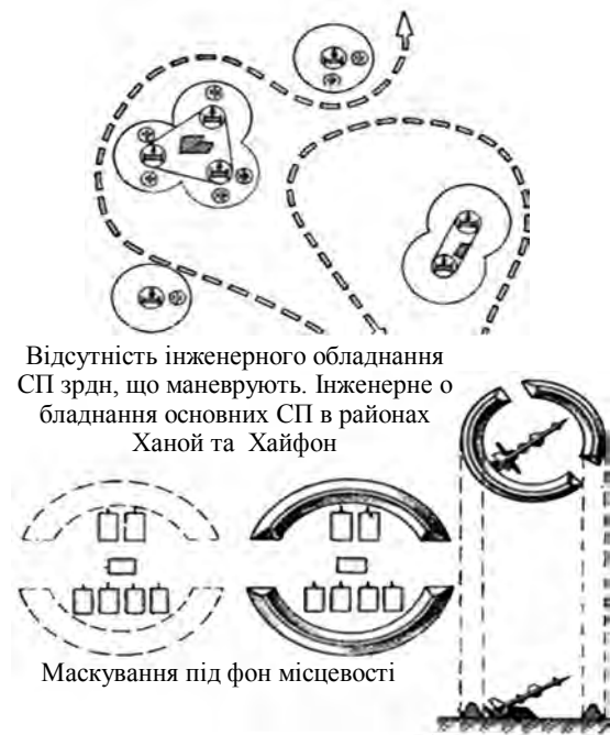
Рис. 1. Побудова системі ЗРП і інженерне обладнання СП зрідн на 1-етапі
