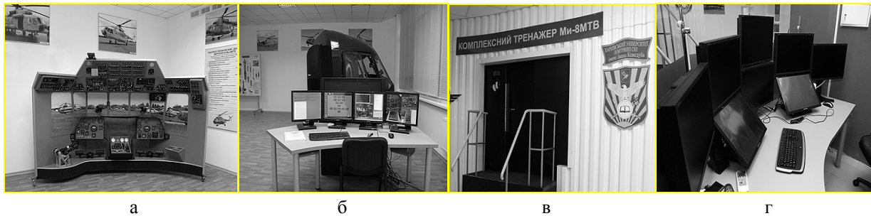
Рис. 1. Тренажер вертольоту "Мі-8 МТВ" а – клас технічної експлуатації вертольоту; б – процедурний тренажер вертольоту; в – тренажерний комплекс вертольоту; г – робоче місце інструктора тренажерного комплексу вертольоту
