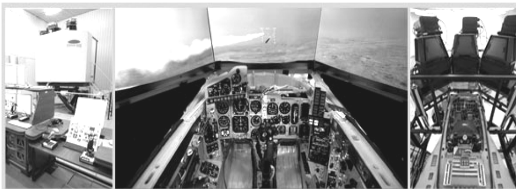
Рис. 3. Динамічний комплексний тренажер літаку МіГ-29 "Сокіл-КТС"
