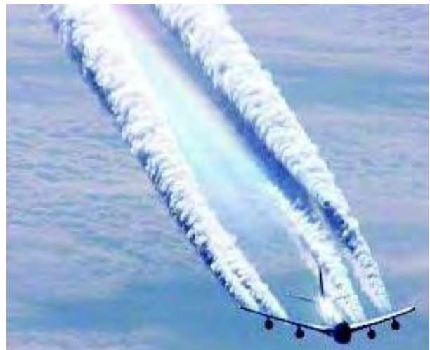
Рис. 1. Вихревой след за магистральным самолетом
