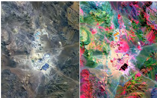
Рис. 3. Приклад зображення ділянки місцевості (пустеля Атакама, Чилі) отриманого в ближній ІЧ (ліворуч) і короткохвильовій ІЧ ділянці спектру (праворуч) за допомогою приладу ASTER супутника Тетта
