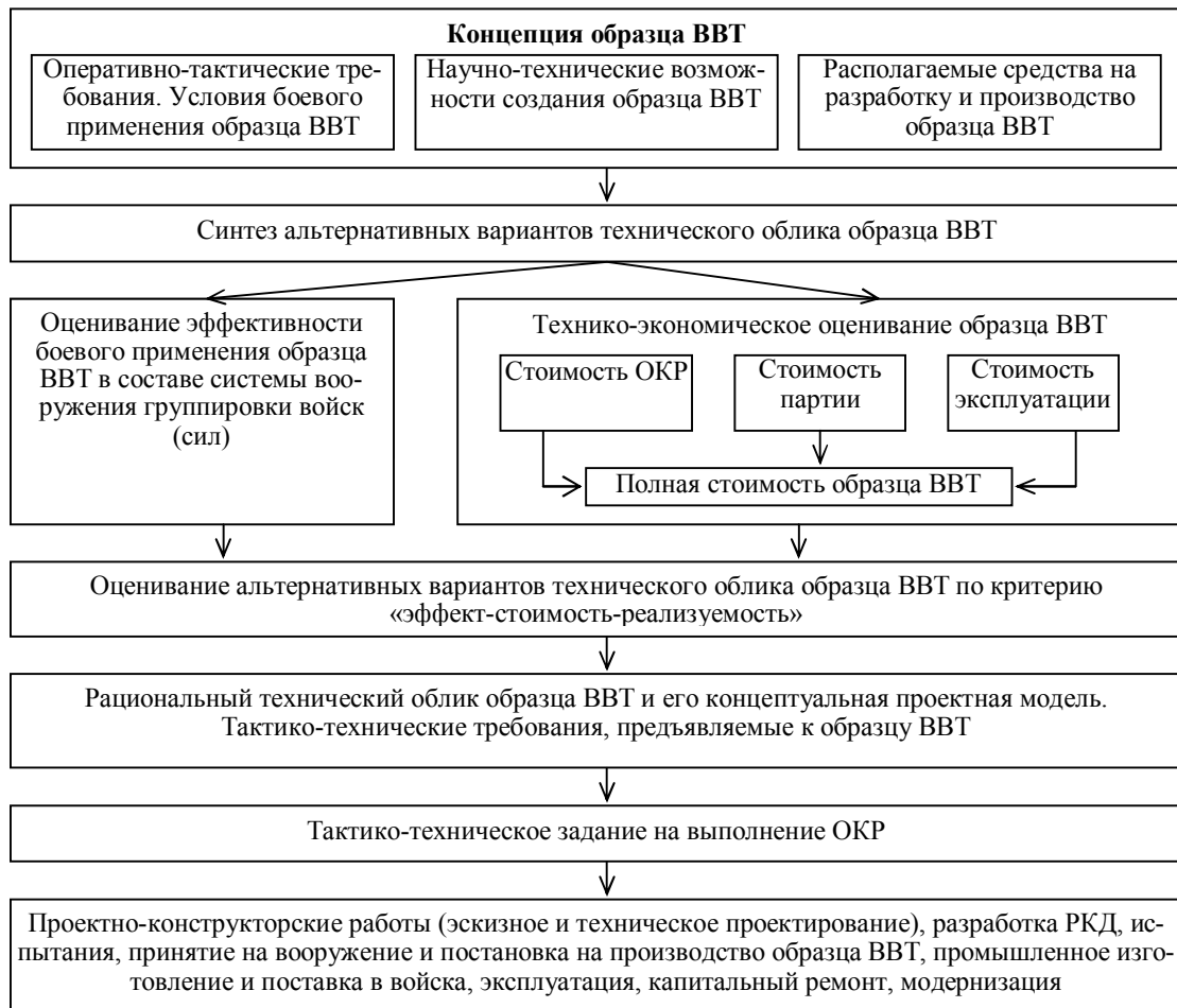
Рис. 1. Структурная схема методики формирования рационального технического облика планируемого к разработке образца ВВТ
