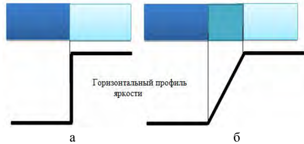
Рис. 8. Модель идеального (а) и наклонного (б) перепадов яркости
