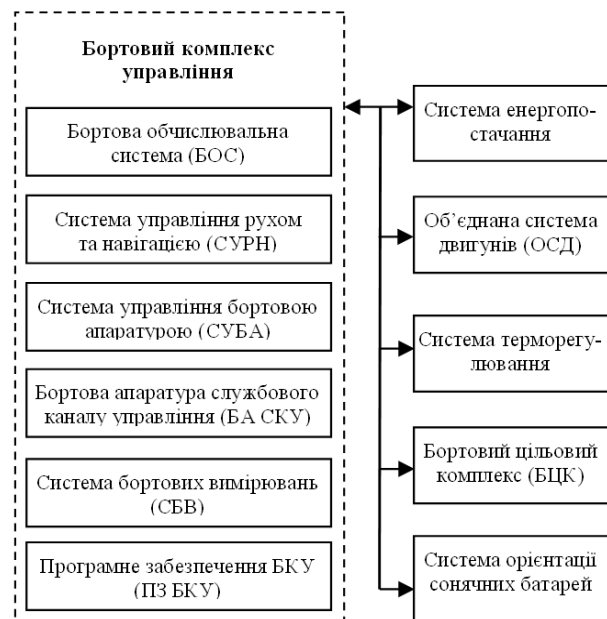
Рис. 2. Бортові системи космічного апарата
