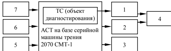
Рис. 4. Структурная схема АСТ: 1 – канал измерения усредненной мощности АЭ; 2 – канал измерения момента трения, температур контакта, износа; 3 – регулятор скорости вращения электропривода; 4 – блок обработки и регистрации; 5 – регулятор уровня нагрузки; 6, 7 – каналы регуляции температуры
