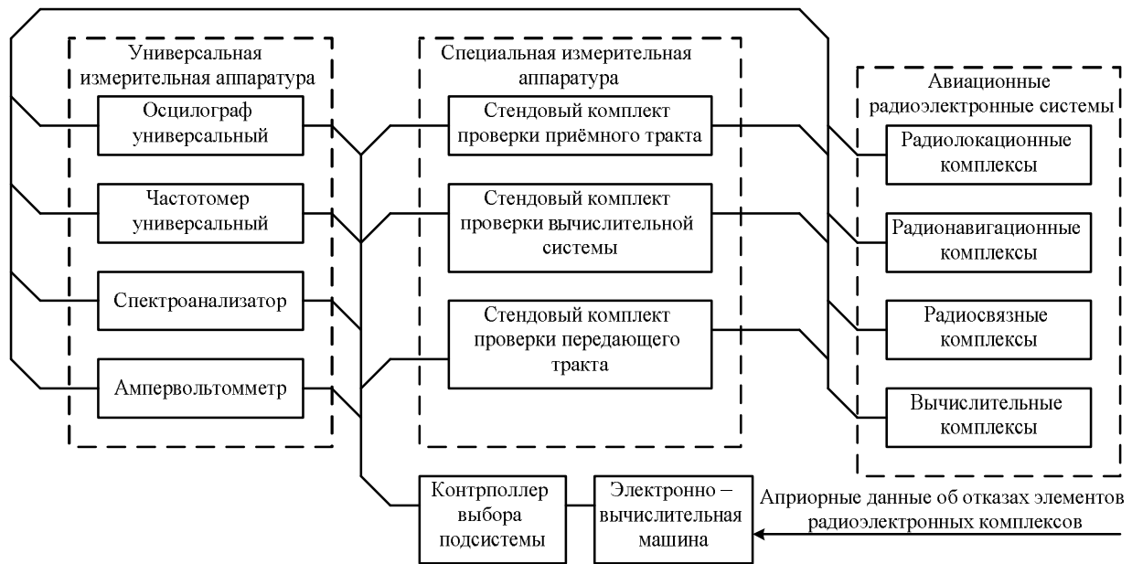
Рис. 2. Перспективная система контроля работоспособности и диагностики АРЭС. Схема электрическая структурная
