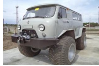
Рис. 1. Всюдиходи розроблені з використанням елементів автомобілів серії УАЗ, ГАЗ
