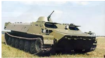
Рис. 2. Варіант МТЛБ модернізованого (об'єкт 6)
