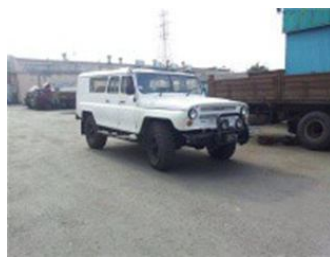
Рис. 1. Всюдиходи розроблені з використанням елементів автомобілів серії УАЗ, ГАЗ
