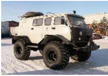
Рис. 1. Всюдиходи розроблені з використанням елементів автомобілів серії УАЗ, ГАЗ
