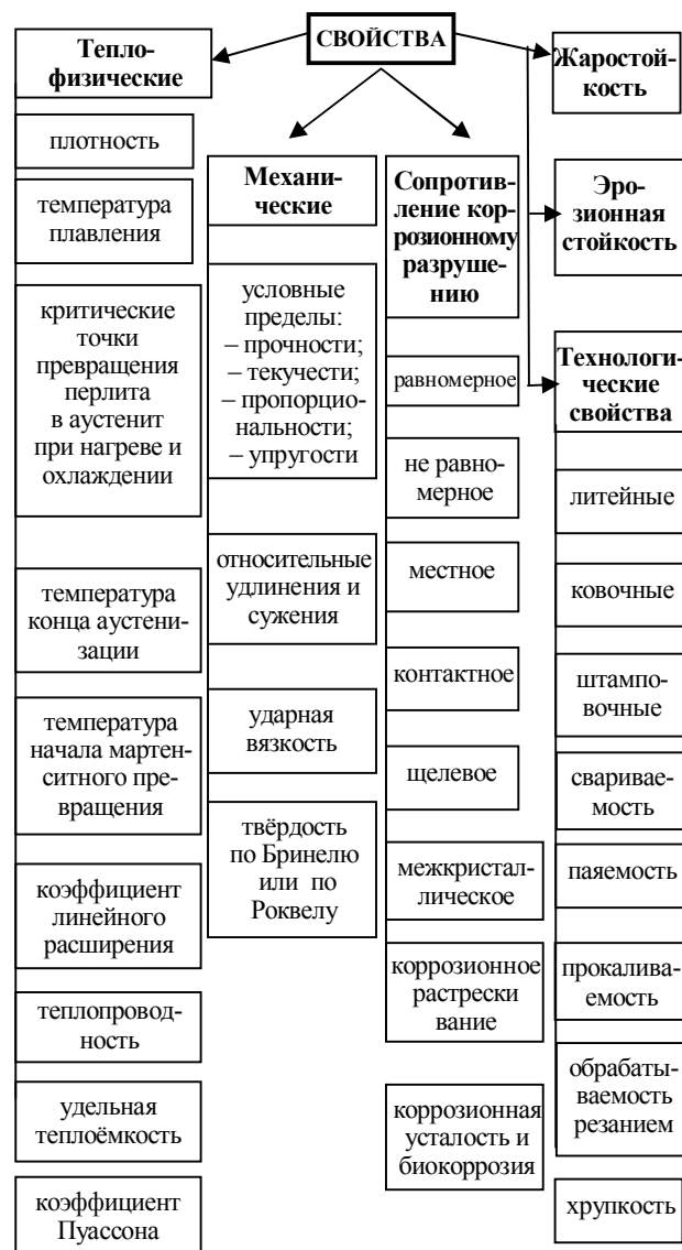
Рис. 1. Свойства, определяющие выбор материала для изготовления деталей к стрелковому оружию
