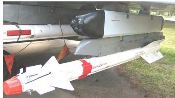
Рис. 2. БКО “Талисман” з авіаційним пусковим пристроєм і ракетою на підкрилових точках підвіски літака МиГ-29
