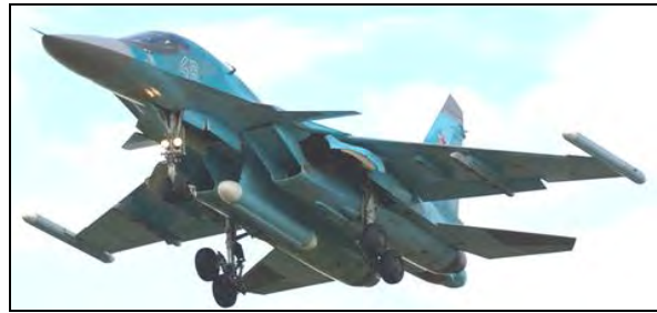
Рис. 3. Літак Су-34 з контейнерами комплексу Л-175В на кінцях крил і з контейнером групової апаратури РЕП під фюзеляжем
