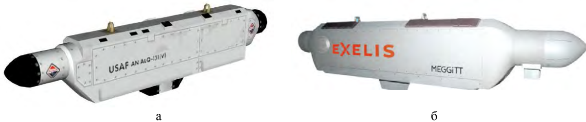
Рис. 1. Зовнішній вигляд підвісних станцій РЕБ індивідуального захисту літаків: а – AN/ALQ-131; б – AN/ALQ-211
