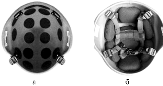
Рис. 2. Підвіска бронешолому, в якій функції оголів'я та ковпаку виконує система рівномірно розподілених амортизаторів (на прикладі моделі MICH TC 2000 ACH Kevlar Helmet (США)): а – внутрішня поверхня корпусу із встановленими фіксуючими дисками зі спеціального пластиру; б – до фіксуючих дисків прикріплені тим'яний та периметральні амортизатори (на фото добре помітно кріплення підборідного ремня до корпусу у чотирьох точках)
