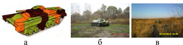
Рис. 2. Маскировочное окрашивание боевой техники: а – летняя БМП; б – весенняя БТР-60ПБ; в – осенняя БТР-70
