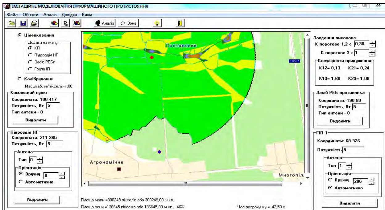
Рис. 3. Зона захисту ПНГ, який має ненаправлену антену РЕЗ
