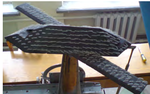
Рис. 11. Фотографія спектру обтікання моделі з крилом прямої стріловидності при \alpha = 10^\circ
