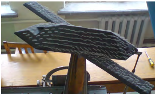
Рис. 15. Фотографія спектру обтікання моделі з крилом прямої стріловидності при \alpha = 16^\circ
