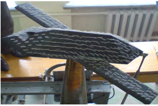
Рис. 13. Фотографія спектру обтікання моделі з крилом прямої стріловидності при \alpha = 14^\circ
