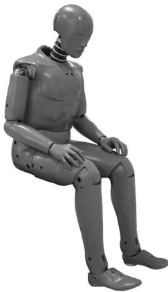
Рис.1. Антропоморфний манекен Hybrid III з 50%-м рівнем репрезентативності
