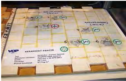
Рис. 2. Бронематеріали на основі комбінованої сталєво-керамічної броні
