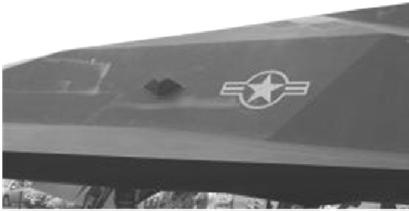
Рис. 1. Отражатель для повышения ЭПР F-117
