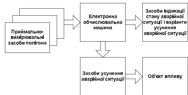
Рис. 3. Загальна структура автоматичної системи контролю безпеки стрільб ЗРС (ЗРК) на полігоні обмежених розмірів
