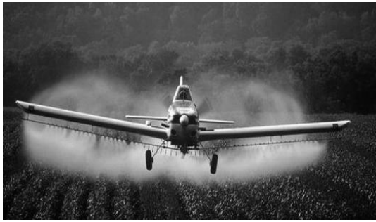
Рис. 7. Влияние эффекта экрана на равномерность распыляемых химикатов
