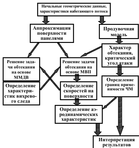
Рис. 1. Структурно-логическая схема комплексного метода определения аэродинамических характеристик сложных пространственных компоновок
