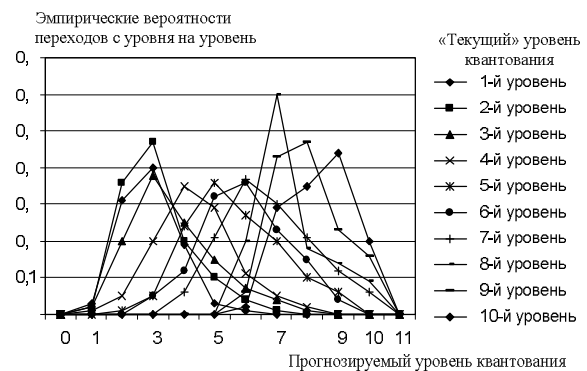
Рис. 6. Плотность распределения эмпирических вероятностей переходов с уровня на уровень при передаче мультисервисного трафика, полученные с помощью известного метода перегрузочного управления трафиком
