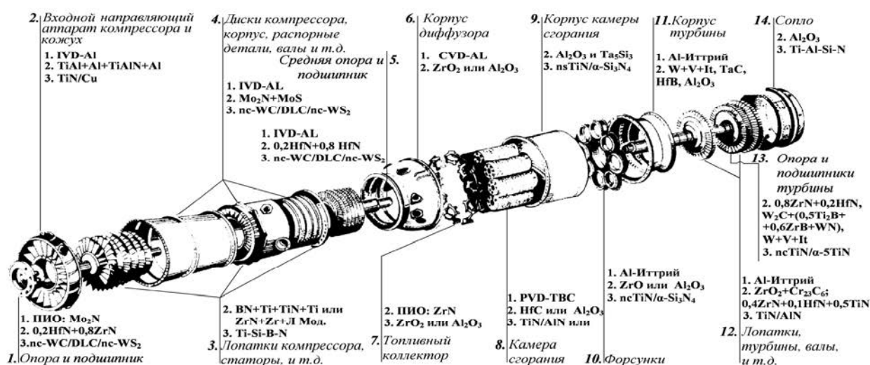
Рис. 1. Покрытия, наноструктуры или виды упрочнений, которые можно эффективно использовать для повышения ресурса и увеличения КПД авиадвигателя
