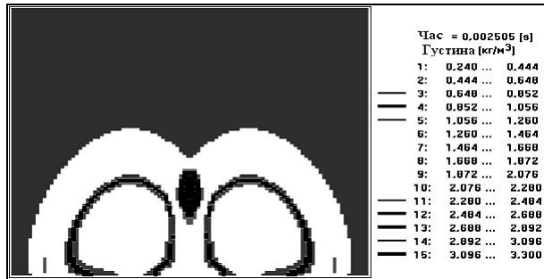
Рис. 4. Поле густини в поперечному перетині 2-х об'ємно-шлангових зарядів, що одержане на момент часу 0,0025 с від початку вибуху
