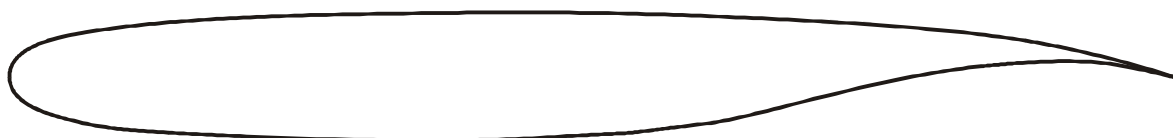
Рис. 1. Сверхкритический профиль McDonnell/Douglas DSMA-523 с острой задней кромкой
