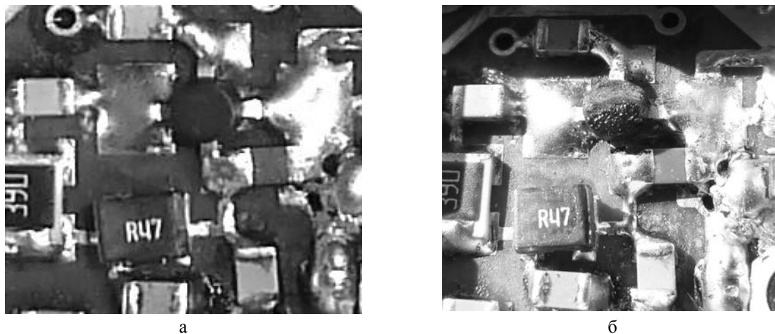
Рис. 9. Изображение функционального узла УРЧ а – до воздействия МЭМИ; б – после воздействия МЭМИ
