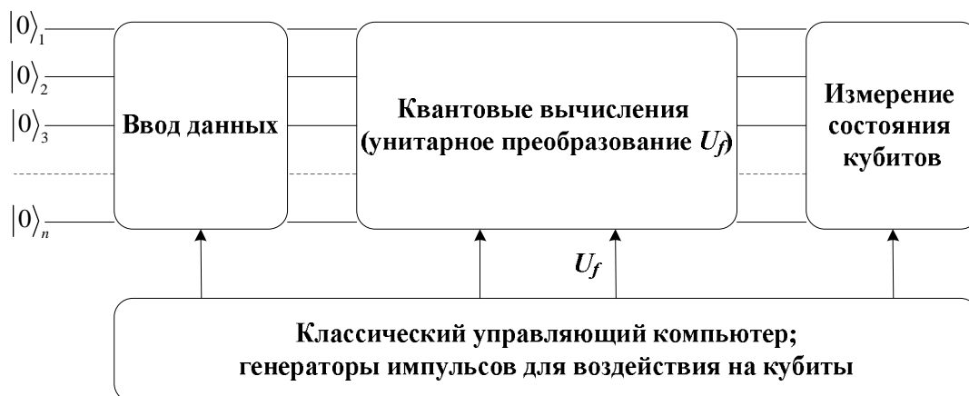
Рис. 1. Структурная схема квантового компьютера
