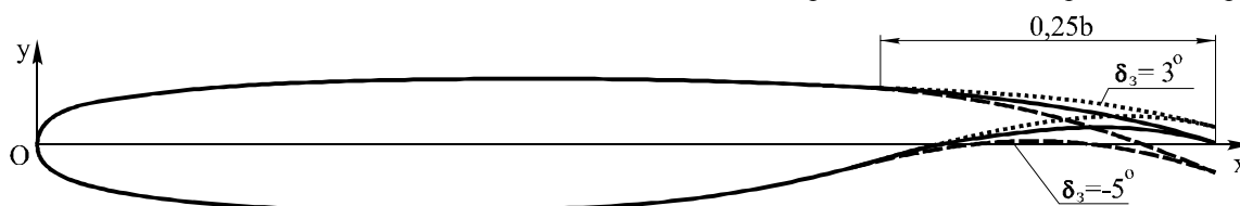
Рис. 1. Сверхкритический профиль McDonnell/Douglas DSMA-523
