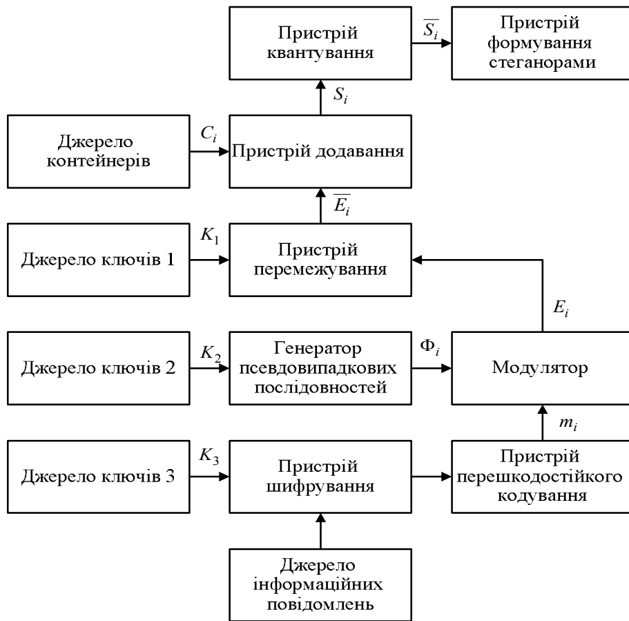
Рис. 1. Структурна схема пристрою стеганографічного приховування даних в просторовій області зображень із використанням прямого розширення спектру
