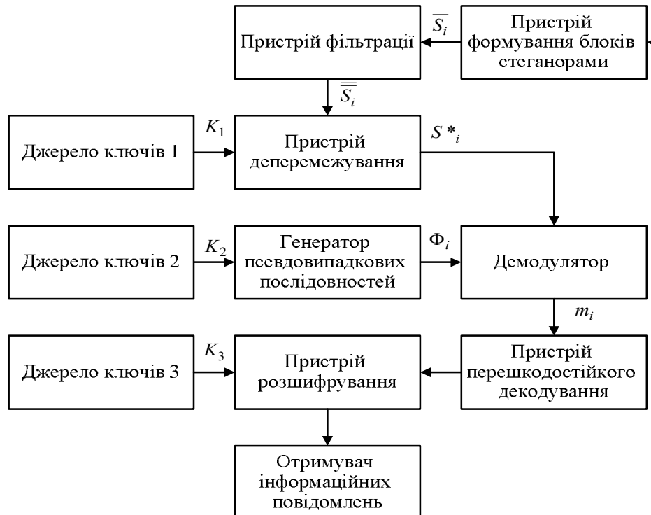
Рис. 2. Структурна схема пристрою стеганографічного вилучення даних з просторової області зображень із використанням прямого розширення спектру
