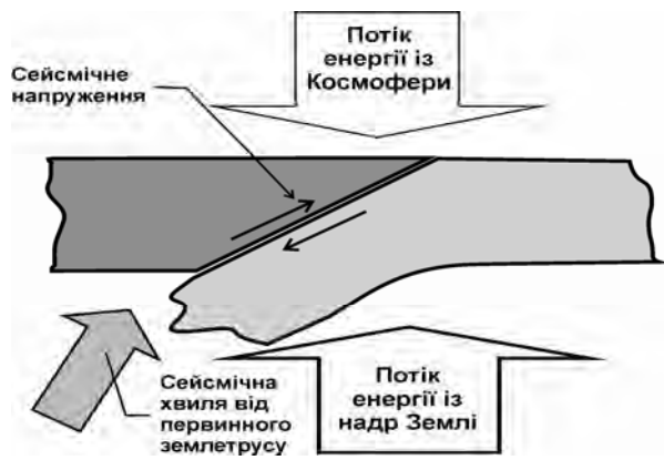
Рис. 4. Схема впливу енергії сейсмічної хвилі від первинного землетрусу на процес розвитку сейсмічного напруження у сейсмічно небезпечних регіонах
