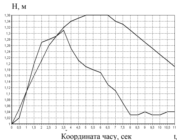
Рис. 5. Залежність відносної частоти обертання та величини напору турбіни від часу
