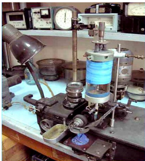
Рис. 3. Зовнішній вигляд і схема установки на абразивне зношування:
