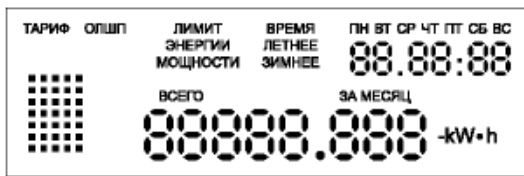
Рис. 4. Загальний вигляд індикатора багатотарифного ЛЕЕ
