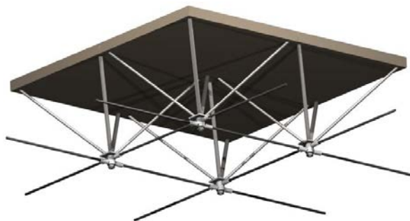
Рис. 1. Фрагмент структурно-вантового сталезалізобетонного покриття
