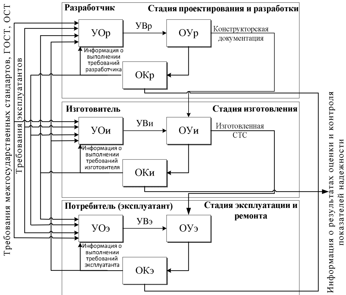
Рис. 2. Схема управления надежностью ТС на стадиях ее жизненного цикла
