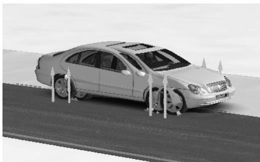
Рис. 13. 3D-анимация поведения автомобилей со стандартной и нечеткой ABS
