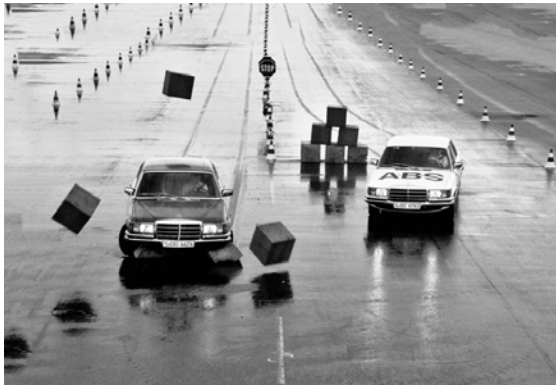
Рис. 2. Поведение автомобилей без и с установленной ABS
