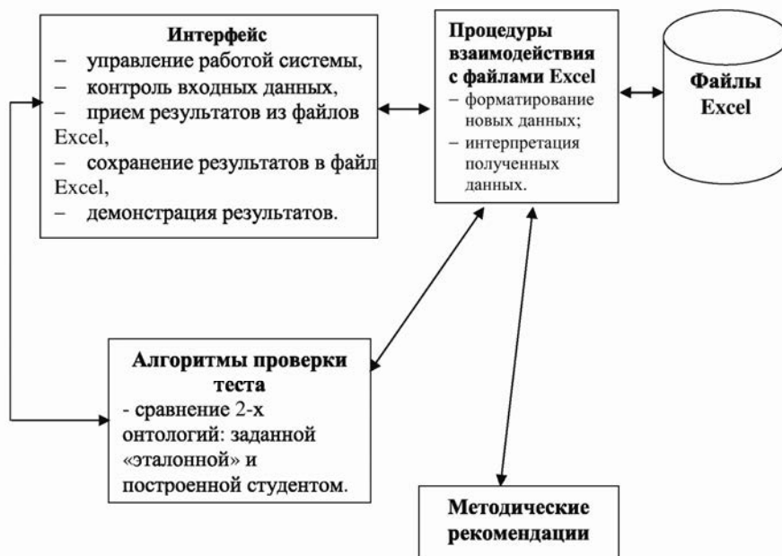
Рис. 3. Функциональная схема прикладного программного обеспечения разработанного программного продукта
