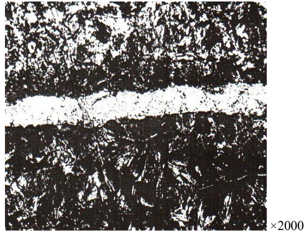
Рис. 1. Микроструктура соединения, паяного в соляной ванне (исходное состояние)
