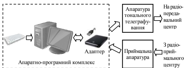
Рис. 1. Схема взаємодії апаратно-програмного комплексу з апаратурою командного пункту
