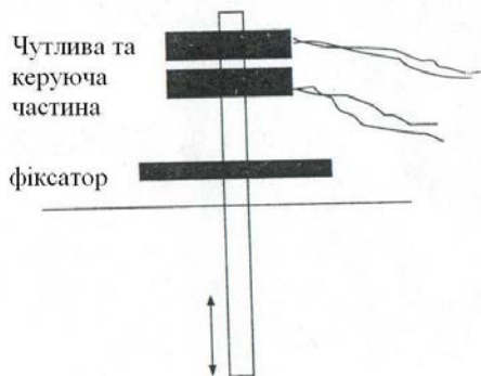
Рис. 3. Вимірювання в'язкості за допомогою вздовж резонуючої пластини
