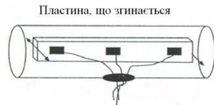
Рис. 4. Гнучка пластина сенсору потоку
