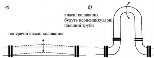
Рис. 4. Приклади сенсорів потоку рідини на вібруючій трубі
