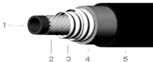
Рис. 3. Конструкция ВТСП-кабеля с теплым диэлектриком: 1 – жидкий азот; 2 – ВТСП-токопроводящая жила; 3 – криостат; 4 – оболочка; 5 – экран
