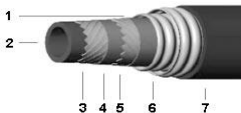
Рис. 2. Конструкция ВТСП-кабеля с холодным диэлектриком: 1 – жидкий азот; 2 – жидкий азот; 3 – ВТСП-токопроводящая жила; 4 – диэлектрик; 5 – ВТСП-экран; 6 – криостат; 7 – оболочка
