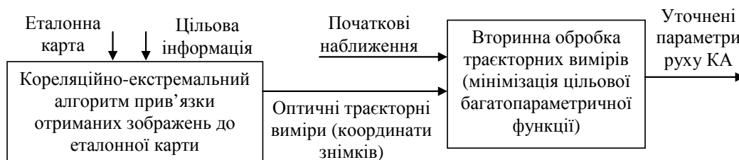
Рис. 1. Схема визначення параметрів руху КА
