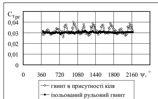
Рис. 4. Залежність розрахованого сумарного коефіцієнта сили тяги РГ Н-форми, що тягне, від кута обертання першої лопаті
