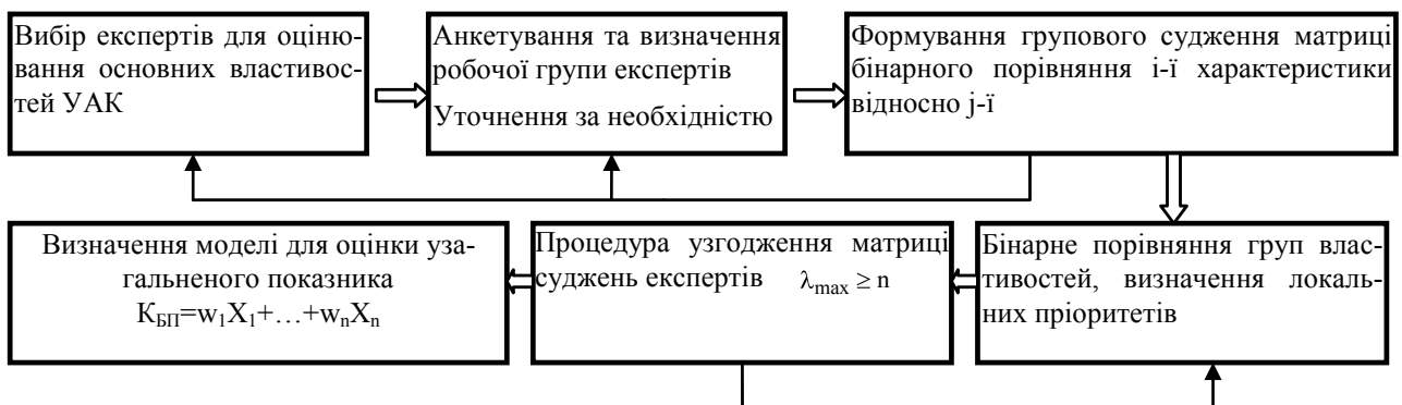
Рис. 1. Процедура визначення вагового внеску основних груп властивостей в узагальнений показник бойової ефективності ( K_{БП} – коефіцієнт бойового потенціалу; w_1 \dots w_n ваговий коефіцієнт кожної з виділених груп властивостей; X_1 \dots X_n – виділені групи властивостей; \lambda_{\max} – максимальне власне значення матриці бінарних порівнянь; n – порядок матриці)
